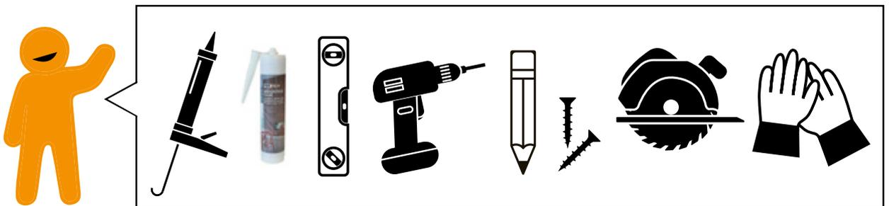
Sie benötigen die FibroTech-Schrauben oder den FibroTech-Montagekleber, eine Wasserwaage, einen Akuschrauber sowie einen Bleistift. Zum Zugschneiden benötigen Sie eine feinzahnige Säge. Verwenden Sie bei der Montage Baumwollhandschuhe.
