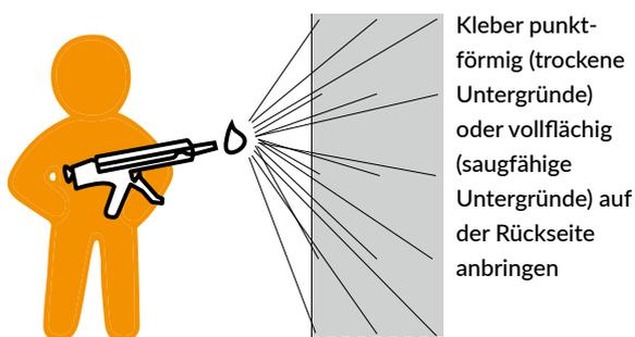
Bei punktförmiger Verklebung benötigen Sie ca. 1 Kartusche je Paneel. Bei vollflächiger Verklebung tragen Sie den Kleber mit einem Zahnpachtel auf, ein Eimer á 2,5 kg reicht für ca. 5 Paneele.
