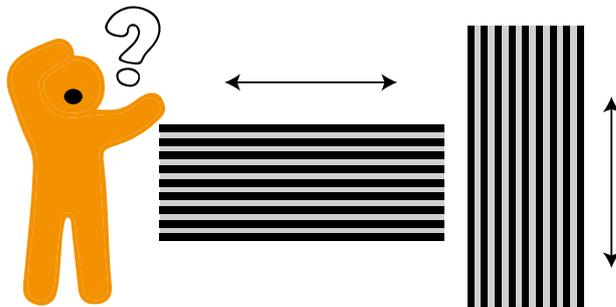
Legen Sie fest, in welche Richtung Sie Ihre Akustik-Paneele montieren möchten. Die Akustik-Paneele können mit einer feinzahnigen Säge zugeschnitten werden.
