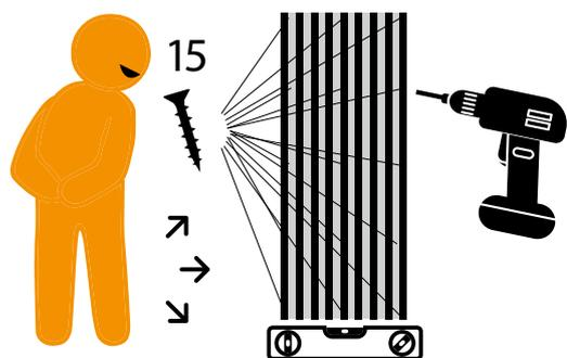
Beim Kleben können einzelne Schrauben hilfreich sein für die Fixierung bis zur Trocknung des Klebers (ca. 10-15 Minuten). Bei Deckenverkleidungen ist ein Verschrauben der Akustik-Paneele zwingend erforderlich. Verwenden Sie ca. 15 Schrauben je Paneel.
