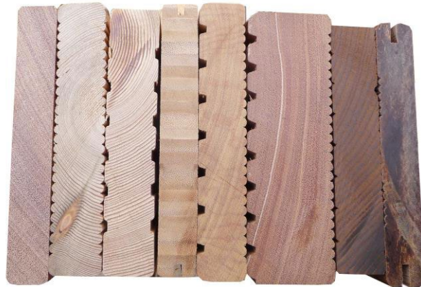
Von links nach recht: glatt/glatt – fein/fein – grob/grob – bombiert – grob/fein – grob/fein – grob genutet – französisch/glatt
