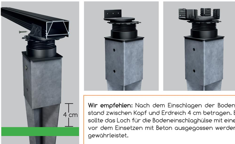
**Wir empfehlen:** Nach dem Einschlagen der Bodeneinschlaghülse sollte der Abstand zwischen Kopf und Erdreich 4 cm betragen. Bei einem zu weichen Erdreich sollte das Loch für die Bodeneinschlaghülse mit einem Erdbohrer vorgebohrt und vor dem Einsetzen mit Beton ausgegossen werden. So ist eine höhere Stabilität gewährleistet.
